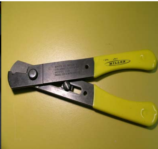
VOL 0560A Pince Miller 100 pour dénuder la gaine extérieure du câble 3M
